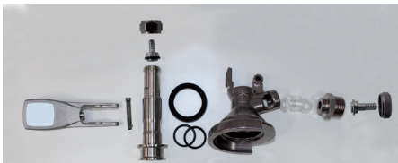
Abb. 6: Links: zerlegter Zapfkopf, rechts: Reinigung eines Zapfkopfes für Bier
