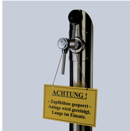
Abb. 8: Warnhinweis am Zapfhahn während der Reinigung
