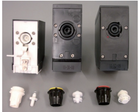
Abb. 5: Zur gründlichen Reinigung zerlegte Zapfhähne für Bier (links) und Postmix (rechts)
